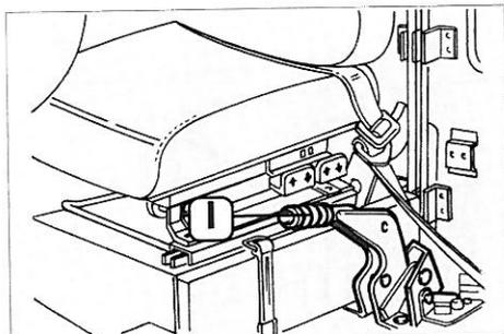
Fig. 81 – Freno di stazionamento
