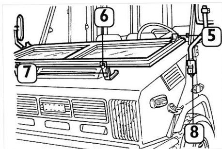
Fig. 28 – Smontaggio e fissaggio parabrezza mediante i bloccaggi 5, i ganci 6 e i fermi 7. Smontaggio specchi laterali mediante viti 8.
