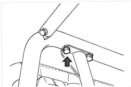
Fig. 34 - Smontaggio barre di sostegno laterali
