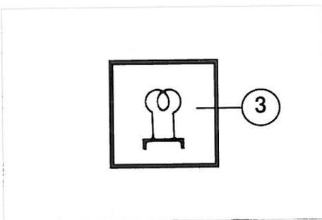
Fig. 79 – Segnalatore luminoso termoavviatore
