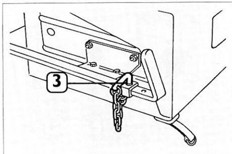
**Fig. 104 – Leva svolgimento elettrico/ manuale**
