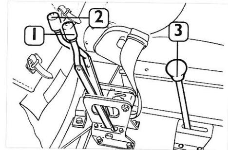
Fig. 12 – Leve comando bloccaggi differenziali, riduttore e innesto trazione anteriore
