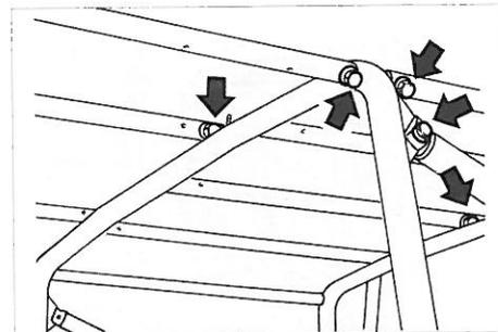
Fig. 33 - Smontaggio centine mediante i dadi indicati dalle frecce
