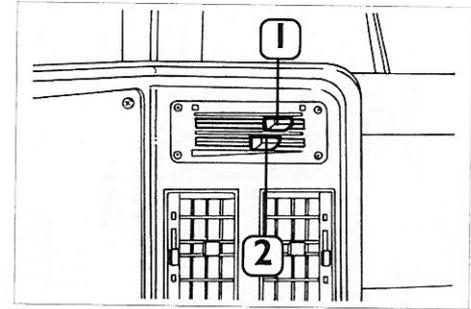
**Fig. 87 – Levetta comando passaggio acqua radiatore/riscaldatore**
