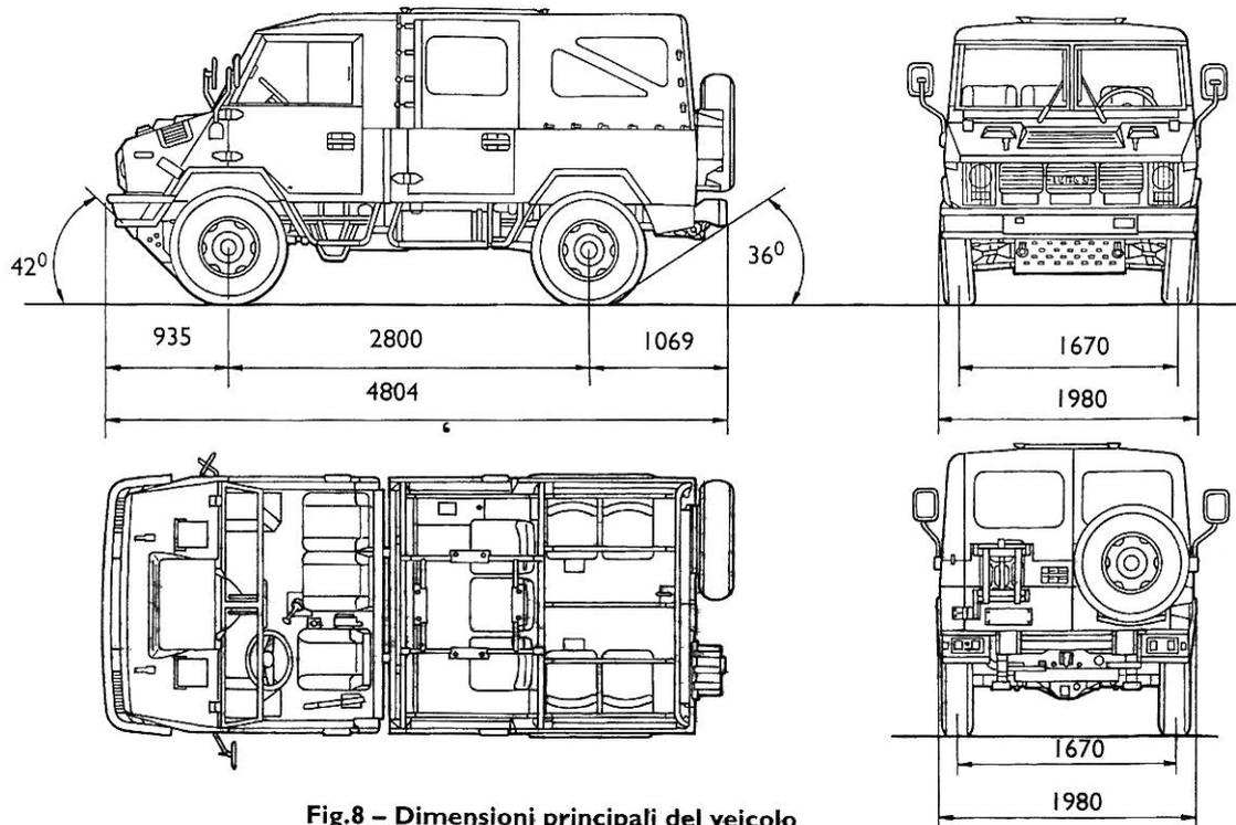
Fig.8 - Dimensioni principali del veicolo
