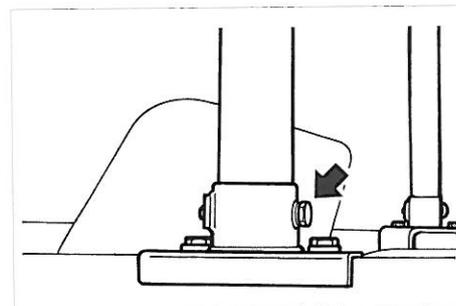
Fig. 35 - Smontaggio barre di sostegno laterali
