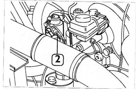
**Fig. 71 – Spurgo aria filtro combustibile**
