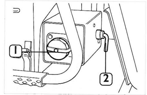
Fig. 40 – Presa bipolare di corrente
