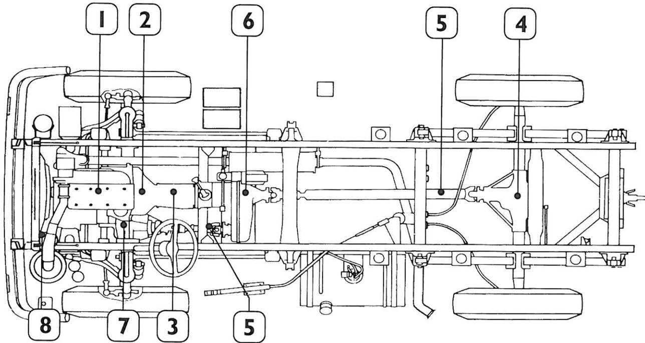
**Fig. 11 – Veicolo in trasparenza con visibili i complessivi principali**
