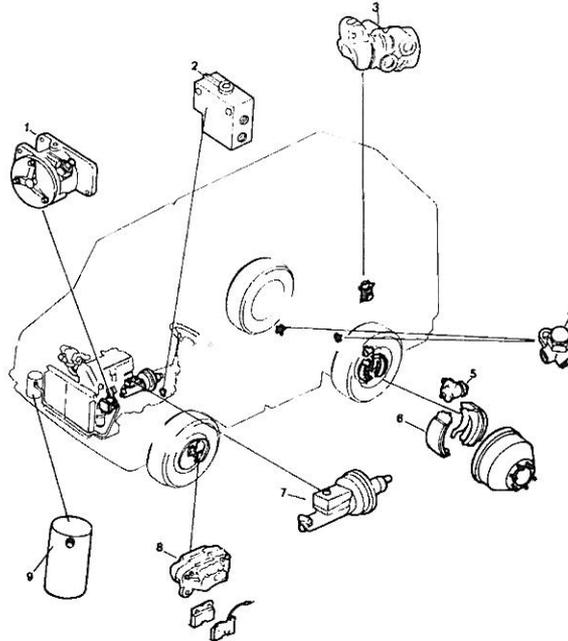
Fig. 106 – Principali componenti impianto idraulico
