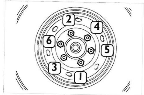
**Fig. 86 – Sequenza fissaggio dadi**
