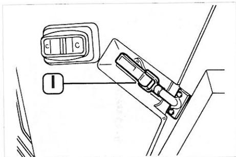
**Fig. 54 – Gancio bloccaggio cofano motore**
