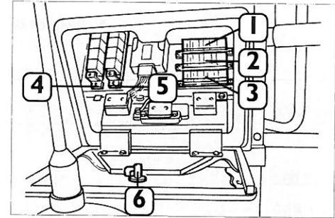
Fig. 105 - Accessibilità fusibili
