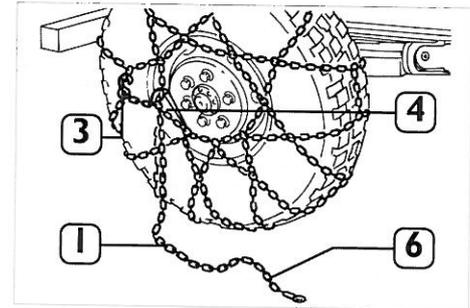
Fig. 17 - Avvolgimento della rimanenza della catena di tensione I
