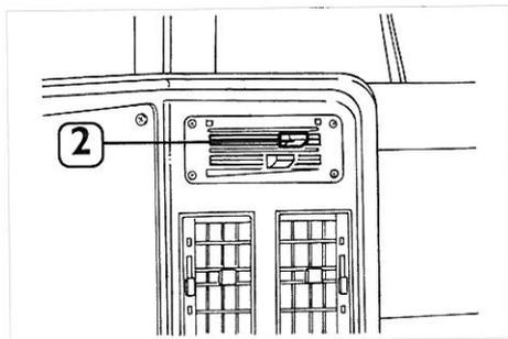
**Fig. 73 – Levetta comando passaggio acqua radiatore/riscaldatore**
