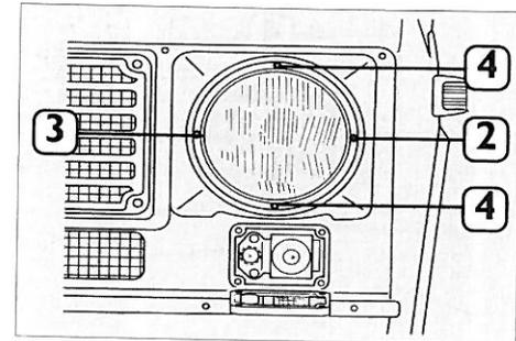
**Fig. 96 – Regolazione orientamento proiettore**
