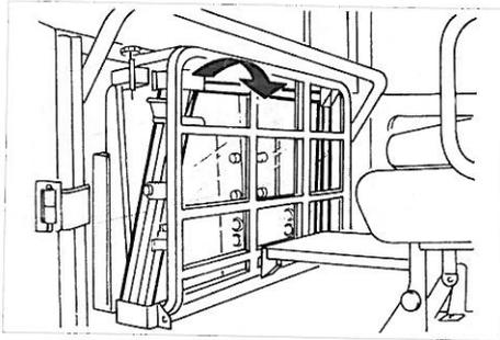
**Fig. 30 – Alloggiamento finestrini laterali (Modello VM 90-T fino al veicolo telaio 17101)**
