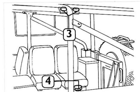
Fig. 27 – Smontaggio cinture e listelli mediante i fermi 3 e i pomelli 4
