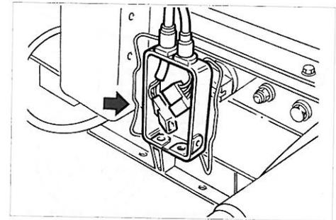
Fig. 44 – Connettore scatola di derivazione
