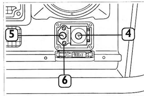
**Fig. 94 – Luce anteriore di direzione e posizione oscurata**
