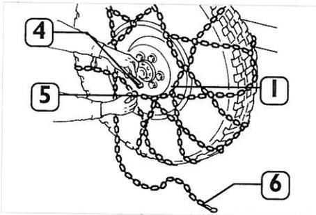
Fig. 16 - Messa in tensione della catena tramite la leva 4
