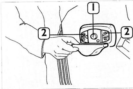
**Fig. 98 – Indicatore laterale di posizione**
