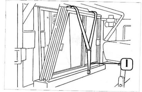
**Fig. 37 – Alloggiamento finestrini laterali con cinghie di fissaggio I (Modello VM 90-T1 dal veicolo telaio I7102)**
