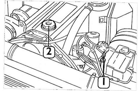
**Fig. 74 – Bocchettone per rifornimento olio e asta di controllo livello**
