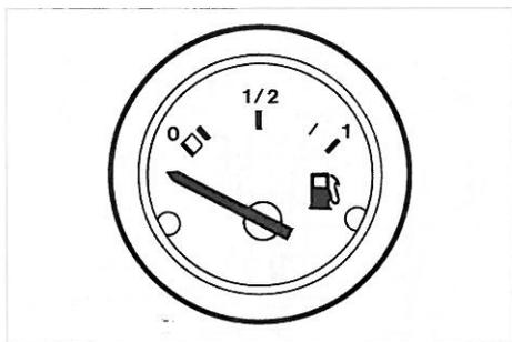
**Fig. 69 – Indicatore livello combustibile**
