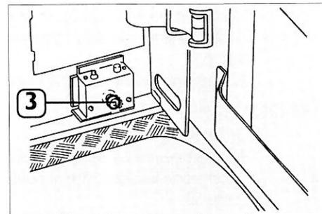
Fig. 63 – Presa per lampada a raggi infrarossi
