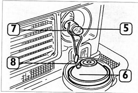
**Fig. 97 – Smontaggio gruppo ottico proiettore**
