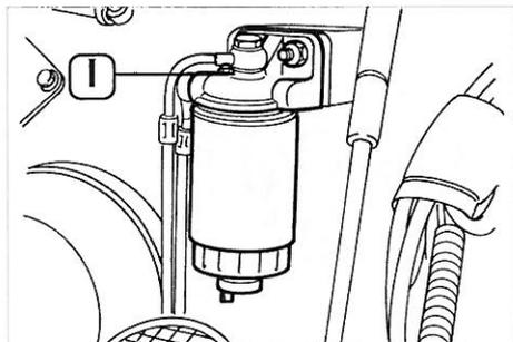
**Fig. 70 – Filtro combustibile**
