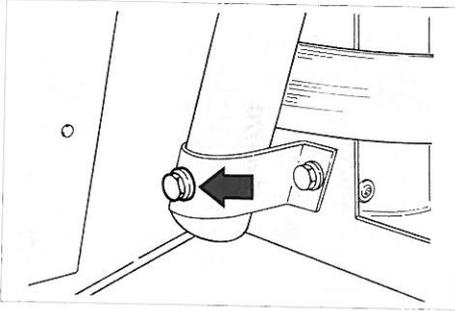
**Fig. 36 – Dado di fissaggio roll-bar anteriore**
