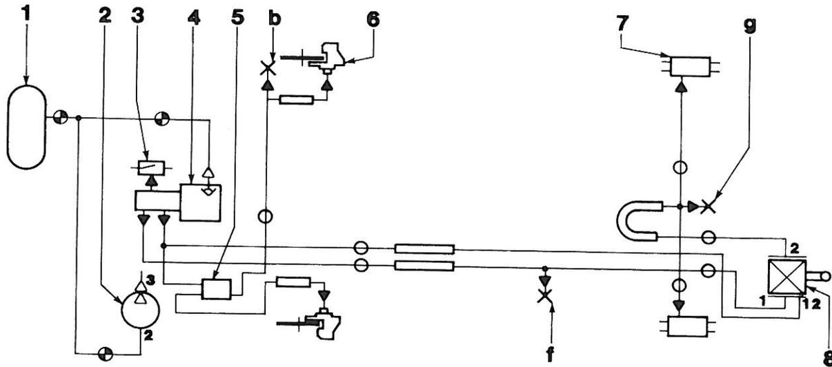
Fig. 107 - Schema impianto idraulico freni
