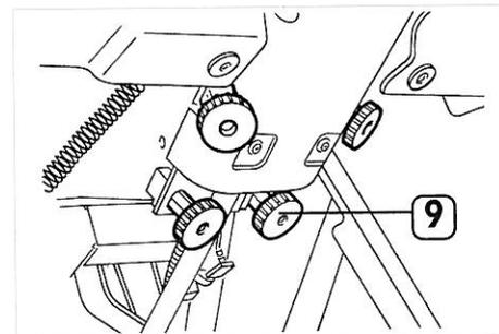
Fig. 29 – Abbattimento volante mediante i pomelli 9
