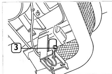
**Fig. 93 – Vite di bloccaggio proiettore oscurato**
