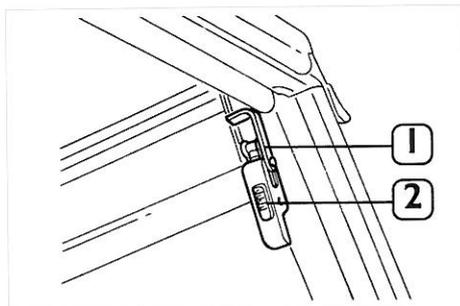
Fig. 26 – Disimpegno parabrezza mediante ganci 1 con sicurezza 2
