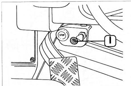
Fig. 61 – Presa per lampada portatile d'ispezione
