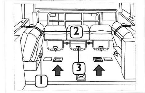
**Fig. 39 – Dislocazione dispositivi per paracadutabilità**
